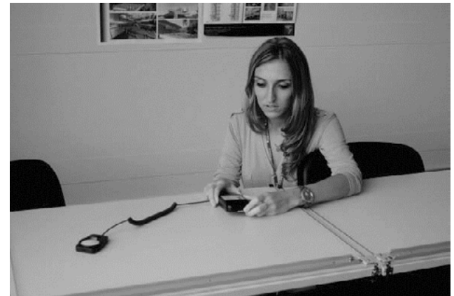
Foto 4 - medição da iluminância Fonte: AUTORA, 2014
