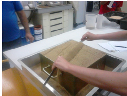
Figura 6 e 7 – Ensaio de massa unitária e ensaio de composição granulométrica Fonte: próprio autor.
