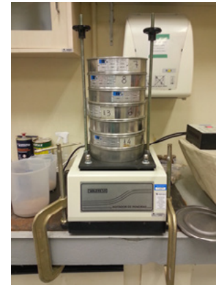
Figura 6 e 7 – Ensaio de massa unitária e ensaio de composição granulométrica Fonte: próprio autor.
