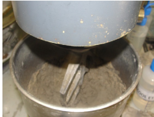
Figura 9 – Argamassa sendo produzida em argamassadeira planetária Fonte: próprio autor.
