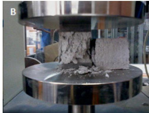
Figura 13 – Corpos de prova para ensaio de resistência à compressão Fonte: próprio autor.
