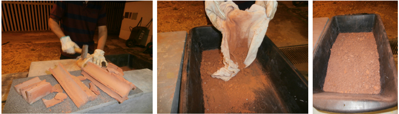
Figura 3, 4 e 5 – Moagem do resíduo Fonte: próprio autor.
